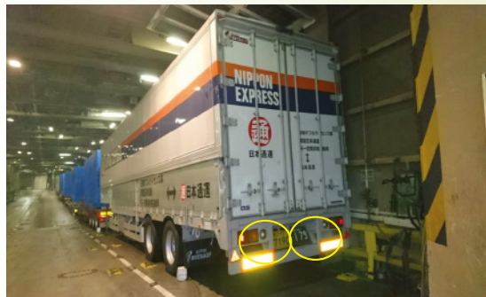
船倉内にシャーシとコンテナ荷台のみ積み込まれ、トラクターヘッドはない。下関から韓国に向かっている。韓国では、韓国のトラクターヘッドがシャーシとコンテナをけん引する。これがシームレス物流である。
