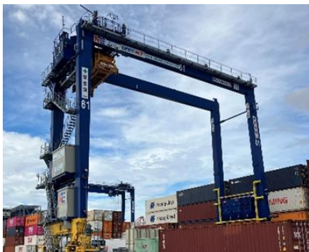
水素燃料電池型RTG
