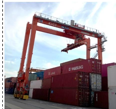
RTG(水素エンジン発電機に換装予定)
